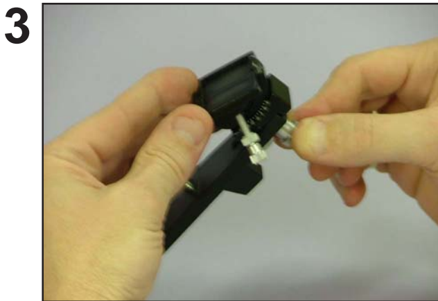
Stellen Sie die Inzisalführung wie gewünscht ein und befestigen Sie sie mit der großen Fingerschraube.
