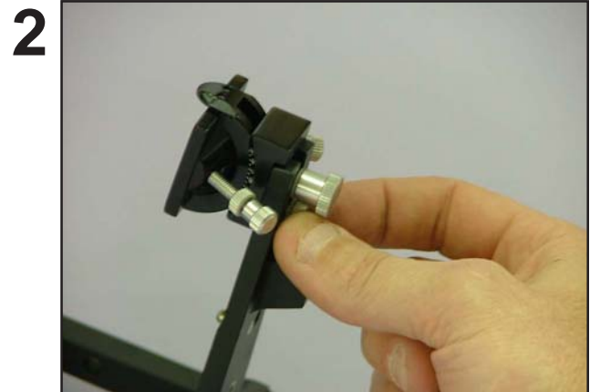
Platzieren Sie den einstellbaren Inzisaltisch und befestigen Sie ihn mit der kleinen Fingerschraube.
