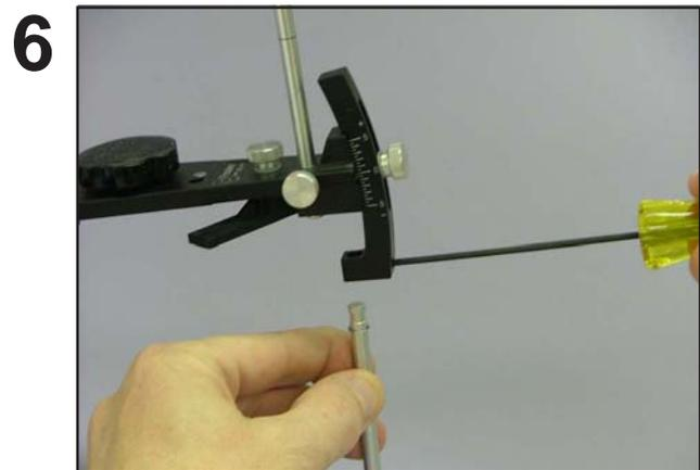
6 Platzieren Sie bei dem (dargestellten) PCH-Artikulator den neuen Löffelpunkt-Inzisaltift mit dem Sechskantschlüssel. Drehen Sie beim SH- oder PSH-Artikulator den Inzisaltift um, sodass der Löffelpunkt nach unten weist.
