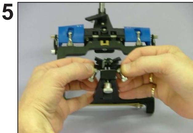
5 Befestigen Sie die seitliche Führung, indem Sie die seitlichen Kontermuttern festziehen.
