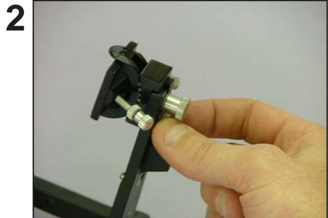
2 Platzieren Sie den einstellbaren Inzisaltisch und befestigen Sie ihn mit der kleinen Fingerschraube.
