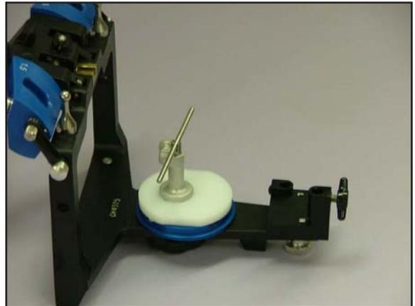
Sicherstellen, dass die Abdruck-Tragstange bis ganz nach unten ausgerichtet ist.
