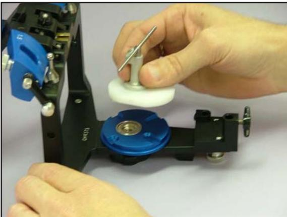
Magnetische Bissgabelstütze zur magnetischen Montageplatte auf dem unteren Rahmen des Artikulators indexieren.
