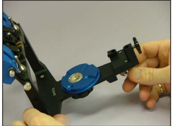
Die Montagevorrichtung in der Inzisaltischaufnahme platzieren und mit der Fingerschraube arretieren.
