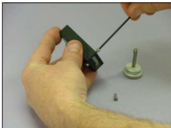
Rimuovere la vite più lunga della piastra di montaggio e le piccole viti di fissaggio del gruppo spaziatore.
