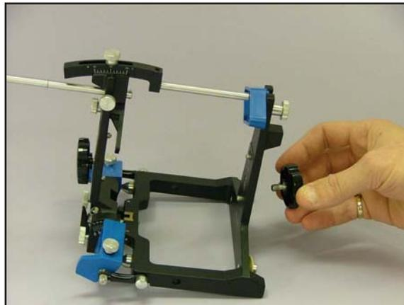
Rimuovere la vite della piastra di montaggio standard svitandola dalla branca inferiore dell'articolatore.
