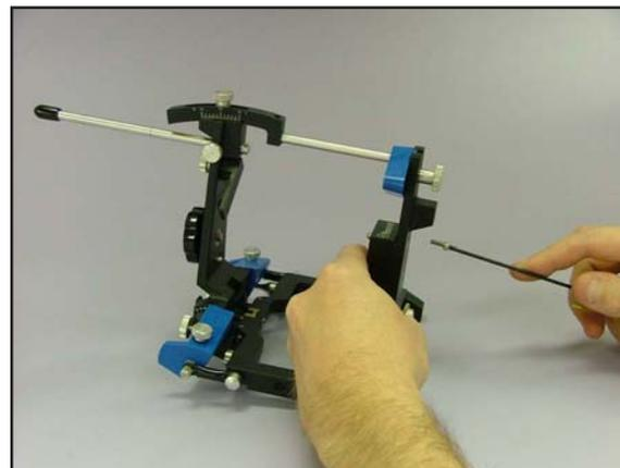
Fissare il gruppo spaziatore sulla branca inferiore dell'articolatore con le viti di fissaggio più piccole.
