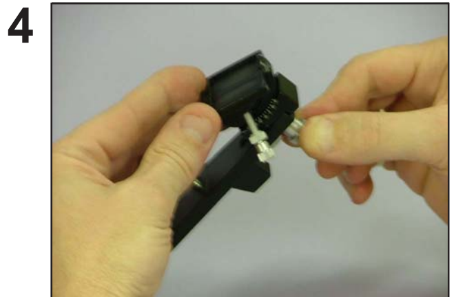
Ajustar la guía lateral deseada con los tornillos de ajuste laterales.
