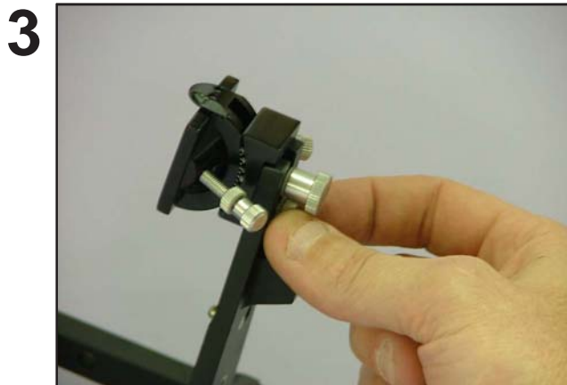
Ajustar la guía incisal deseada y asegurarla en su lugar con el tornillo grande.
