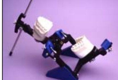
(6.) Abrir el bastidor superior para apoyarlo en el perno de apoyo para facilitar procedimientos de laboratorio.
