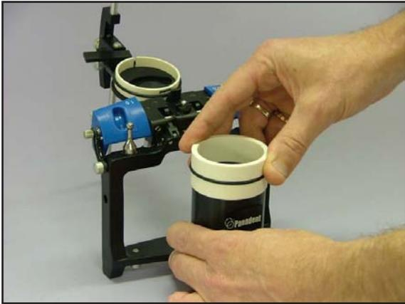
Platzieren Sie den PCV-Haltering oben auf der Testsäule, um den Gips zu kontrollieren.
