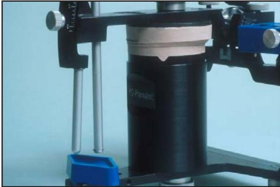
Überprüfen sie die Sitzgenauigkeit zwischen Steinindex und Testsäule. Testsäule und Steinindex können auf anderen Artikulatoren vom Typ "P" platziert werden, um die Auswechselbarkeit zu überprüfen. Falls Sie Diskrepanzen feststellen, fordern Sie telefonisch Unterstützung von Panadent an.
