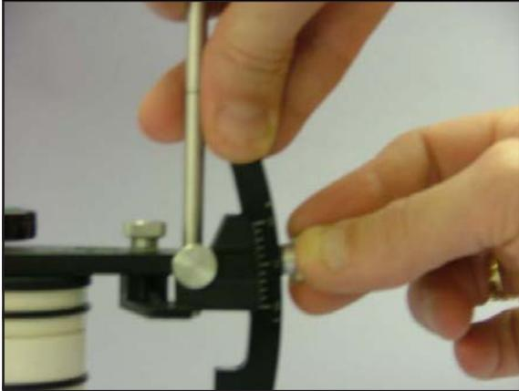
Stellen Sie den Inzisalstift auf null und achten Sie darauf, dass der mittlere Riegel eingerastet ist.
