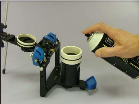
Bringen Sie Silikon-Schmiermittelspray auf die obere Fläche der Testsäule und die Rahmen des Artikulators auf, damit der Gips nicht haften bleibt.
